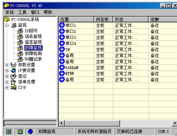
本窗口实时监测 CPU 板的状况，具体有串口 1、串口 2、串口 3、串口 4、时钟、64KRAM 的监视等。运行正常时状态显示为正常，工作异常时会有红色提示，而交换机与系统未连接时则显示为问号，做到出现任何问题就能马上知道。
