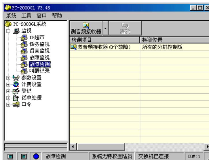
故障检测包括音频发生器检测、音频接收器检测。
