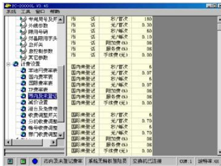
计费设置窗口分列了本地、国内、国际、IP 的费率表，以及打折与免费电话的设置，各种收费的调整，以适应不同的计费方式。本系统的话费计费方法采用按秒计费，同时也可以部分采用按分计费，完全符合我国电信资费调整后的各地收费标准。
