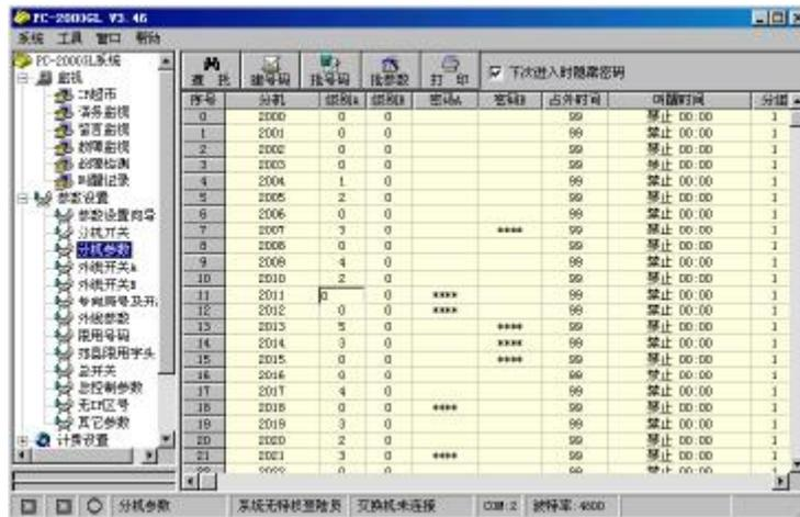
参数设置窗口内包含了 10 多个分门别类的窗口，其中有“分机开关”、“分机参数”、“外线开关 A\B”、“专向局号及开关”、“外线参数”、“限用号码”、“郊县限用字头”、“总开关”、“总控制参数”、“无 IP 区号”、“其它参数”等窗口，把调度主机的参数与开关分类详细划分，一目了然，使用户设置更加得心应手。
